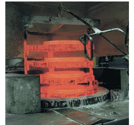
Erhöhung der Verschleiß- und Dauerfestigkeit durch Einsatzhärten
