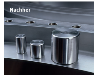
Nachher Nachgeschliffene Laufbahn, neue Rollen mit angepasstem Übermaß
