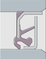
00019185   | Joint d'étanchéité à cassette avec deux bagues en forme d'équerre en acier inoxydable et trois lèvres surmoulées. Les bagues en forme d'équerre sont montées sur les bagues inter. et exter. La lèvre intérieure, la lèvre principale et la lèvre axiale sont préchargées. La graisse accumulée entre les trois lèvres sert de lubrification et de protection supplémentaire contre les impuretés. |
