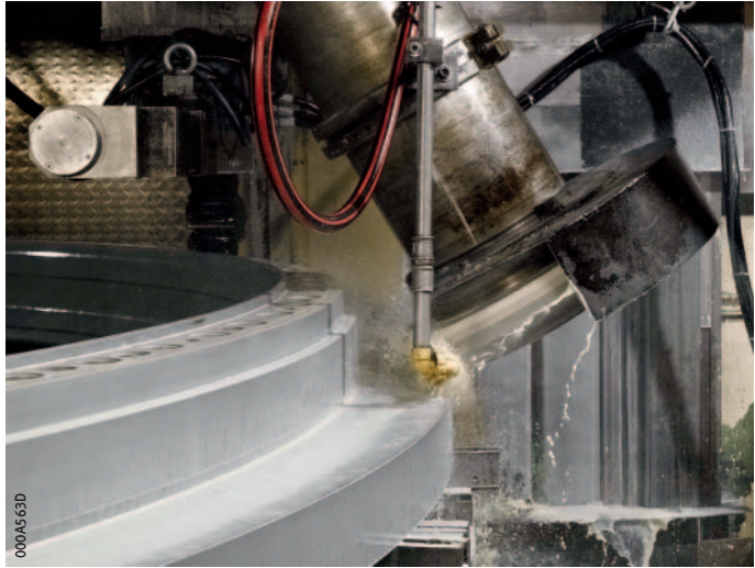
Figure 7 Rectification des roulements de grandes dimensions
