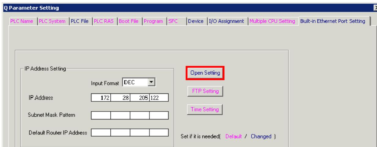
5. Haga clic en la pestaña **Built-in Ethernet Port Setting** en **Open Setting**.
