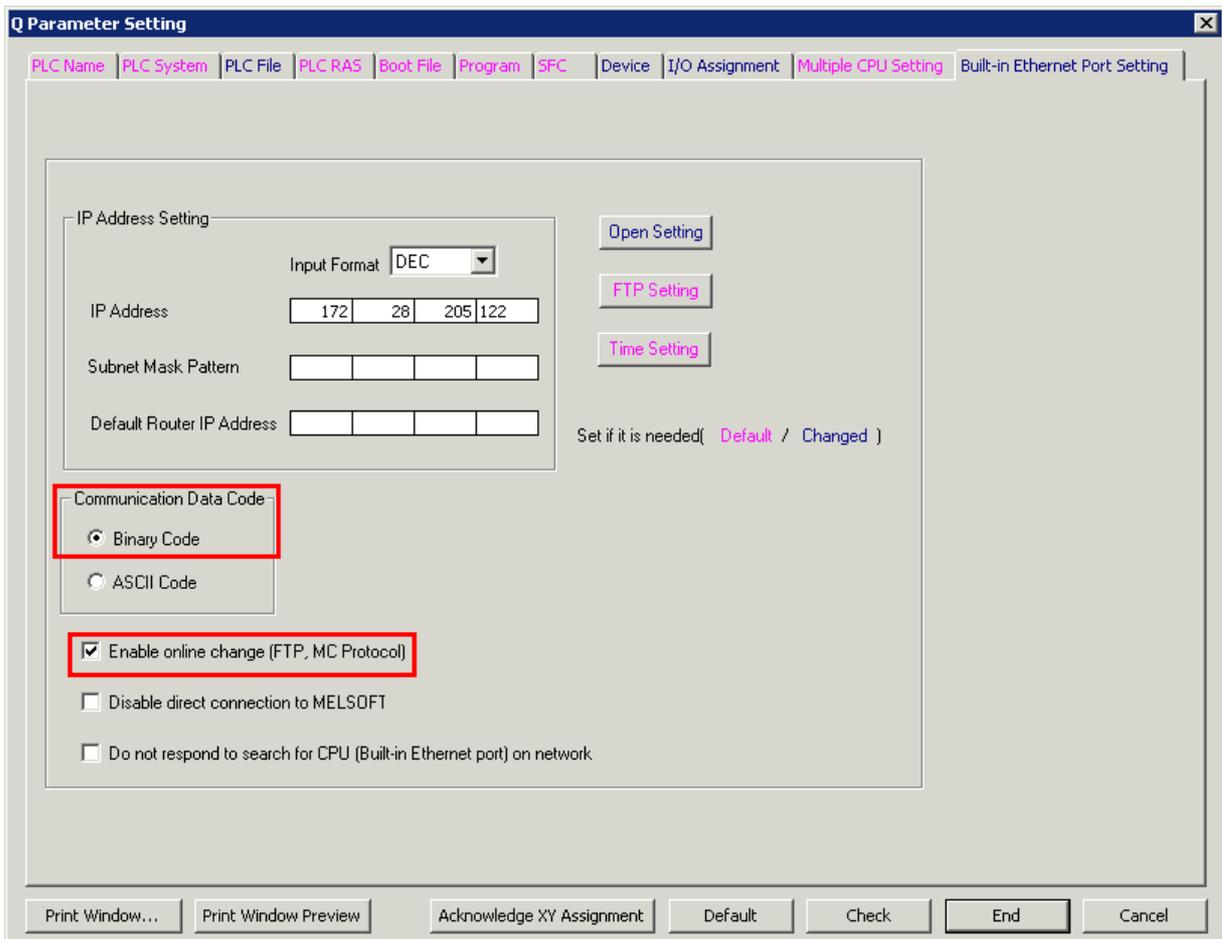
8. En **Communication Data Code**, configure el modo de transferencia **Binary Code**.
