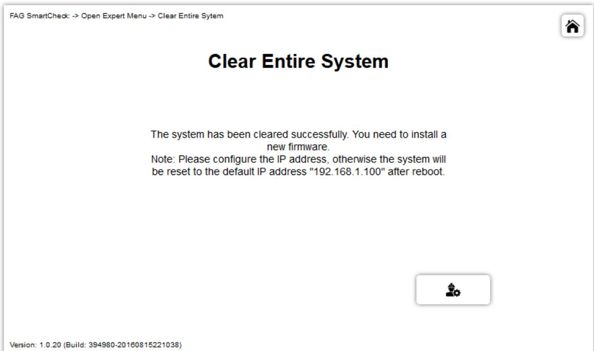
2. Debe instalar un nuevo firmware. Además, debe volver a configurar la dirección IP del dispositivo SmartCheck o ProLink ya que esta acción la restablece a la dirección IP estándar.
