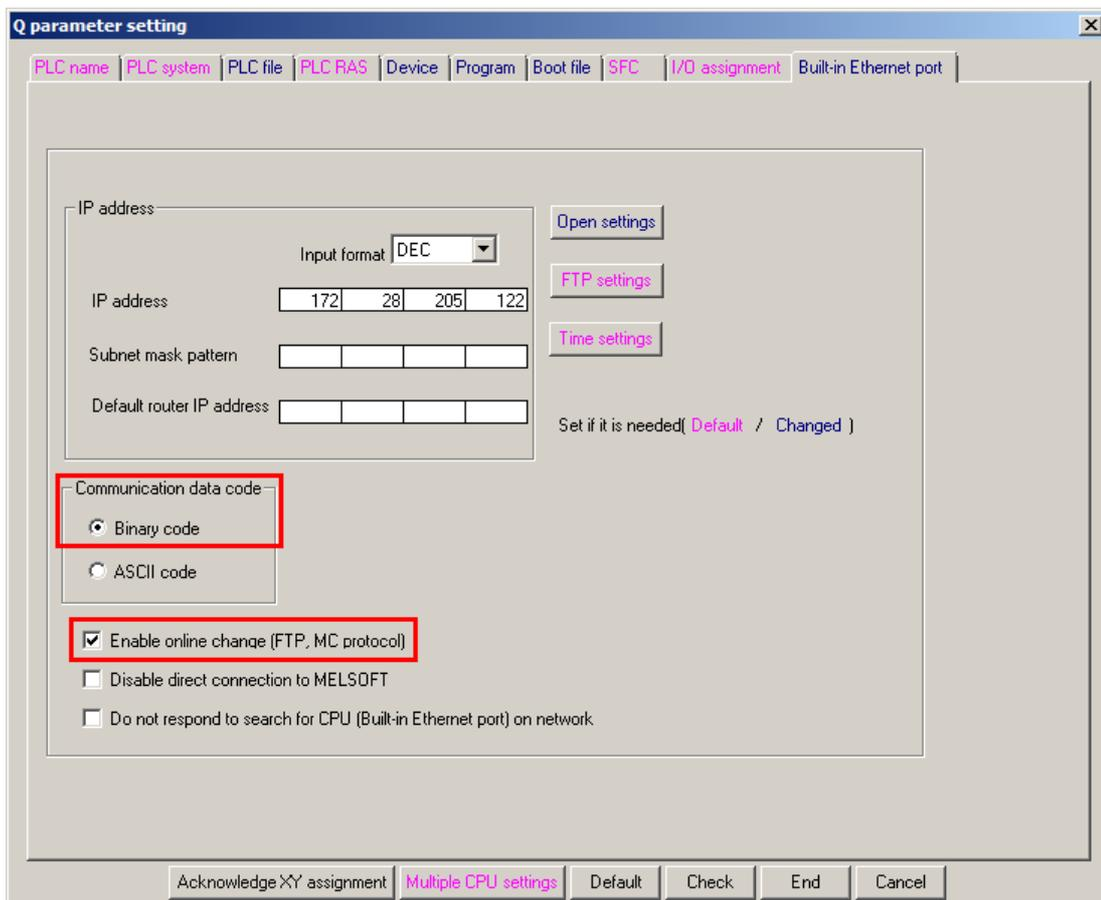
8. En **Communication Data Code**, configure el modo de transferencia **Binary Code**.
