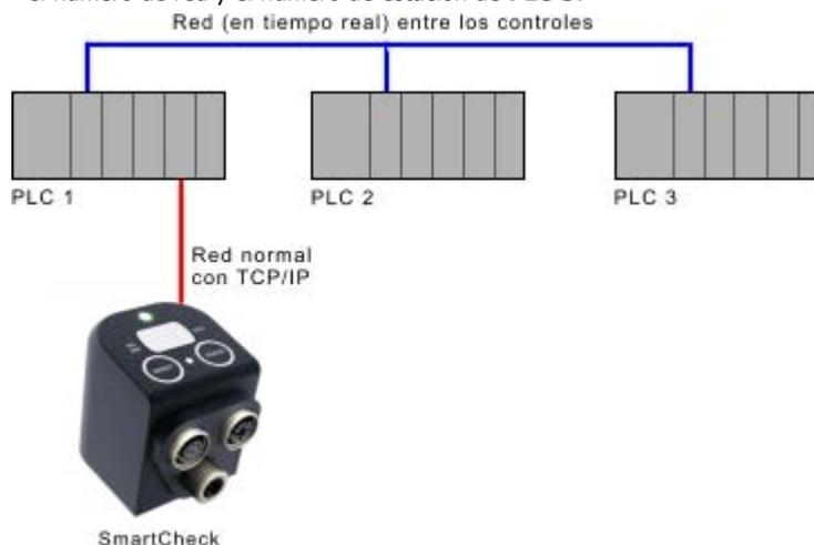
Los datos del dispositivo Schaeffler SmartCheck o ProLink se transmiten de PLC 1 a PLC 3 por la red en tiempo real.
