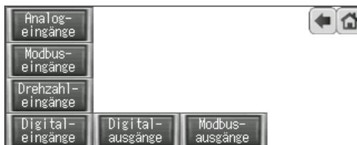
Sie können sich hier für die einzelnen Eingänge und Ausgänge direkt die Registerinhalte des FAG SmartControllers anzeigen lassen. Dies macht insbesondere die Inbetriebnahme des Geräts einfacher. Details zu den Auswahlmöglichkeiten finden Sie in den folgenden Abschnitten.
