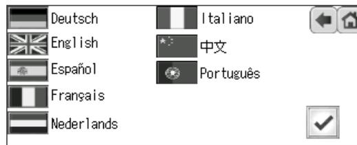
Sie finden hier für jede unterstützte Display-Sprache eine Landesflagge als Schaltfläche. Tippen Sie auf diese Schaltfläche, um die derzeitige Spracheinstellung entsprechend zu ändern. Standardmäßig ist Englisch eingestellt.
