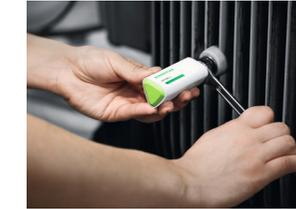
Les capteurs sont vissés ou collés sur les équipements et activés pas NFC. Tous les capteurs se connectent automatiquement entre eux et à la passerelle. Ensemble, ils forment un réseau maillé, l'un des réseaux IdO les plus fiables et les plus économes en énergie du secteur. Il est possible d'ajouter d'autres points de mesure au système à tout moment.
