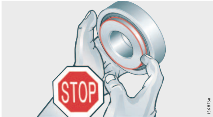
Fig. 5 Ne pas démonter la bague intérieure
