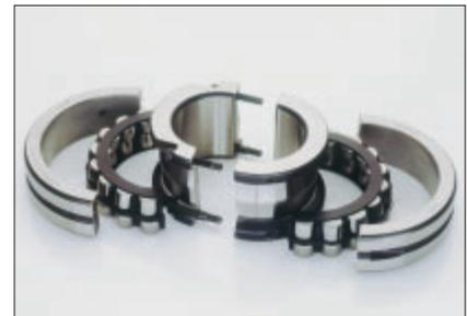
4: Roulement à rotule sur deux rangées de rouleaux en deux parties avec cage en laiton en deux parties en polyamide renforcé de fibres de verre ou en laiton, bagues de blocage intégrées.
