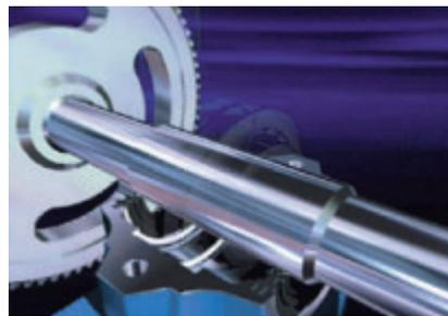
5 Montage des pièces restantes, avec en dernier la partie supérieure de la bague extérieure.
