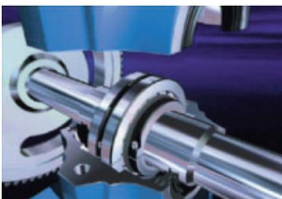
7 Monter la partie supérieure du corps de palier.
