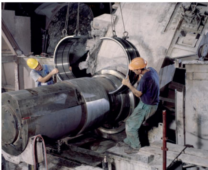
Montage d'un roulement à rotule sur deux rangées de rouleaux en deux parties de grandes dimensions
