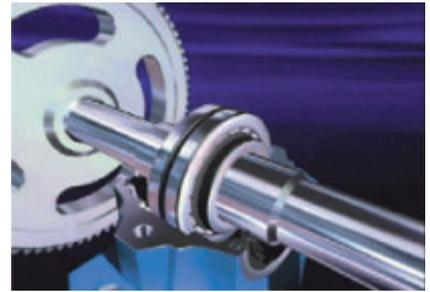
3 Démontez l'ancien roulement (découper avec précaution le roulement monoblocs avec manchon de serrage à l'aide d'un disque à tronçonner).
