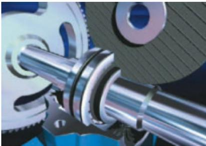
4 Poser l'une des parties de la bague extérieure dans la partie inférieure du corps de palier et aligner la bague intérieure montée sur l'arbre puis visser les deux parties de la bague intérieure.
