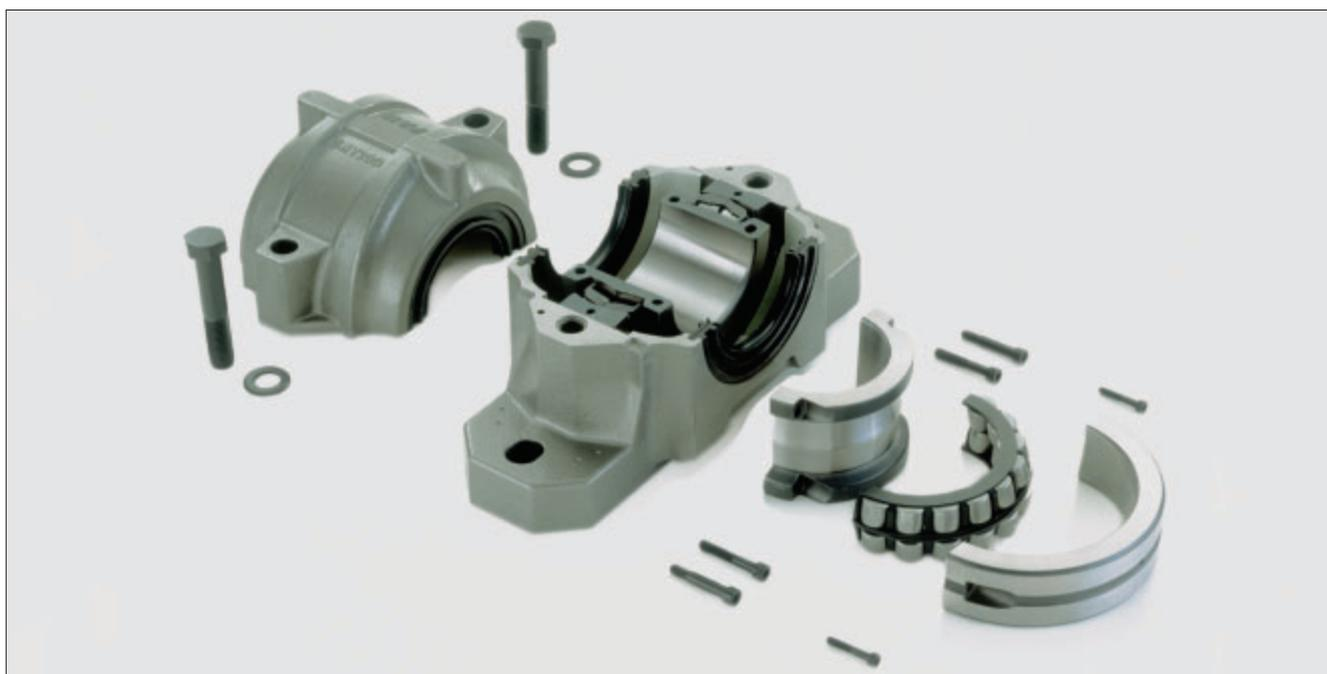
2: Contrôle simplifié, montage rapide et facile - Roulement à rotule sur deux rangées de rouleaux en deux parties prêt à être monté dans un corps de palier SNV.
