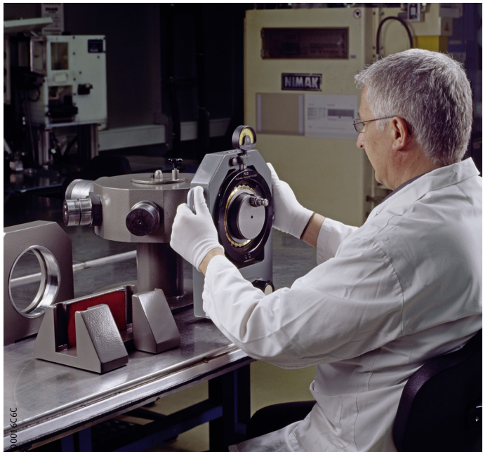
Figure 4 Pose de l'instrument de mesure du cercle inscrit aux rouleaux
