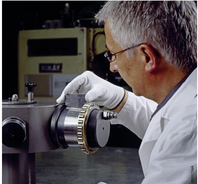
Figure 5 Détermination de l'entraxe jusqu'à l'épaulement d'arbre
