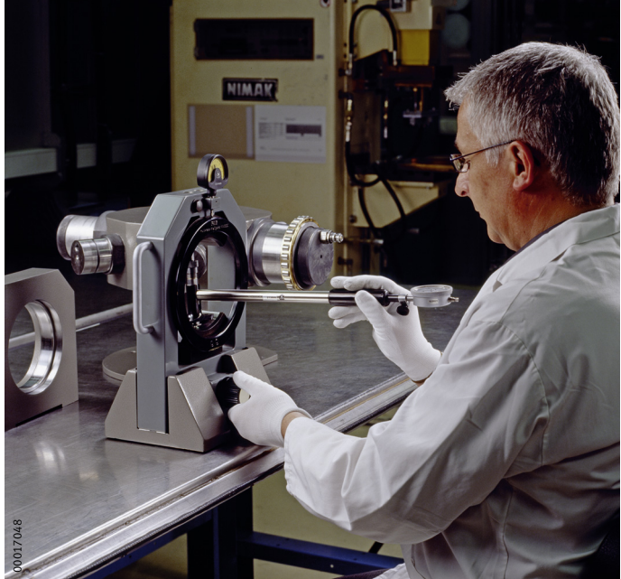
Figure 3 Report du diamètre du chemin de roulement sur l'instrument de mesure du cercle inscrit aux rouleaux
