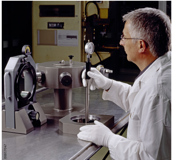
Figure 2 Détermination du diamètre du chemin de roulement de la bague extérieure
