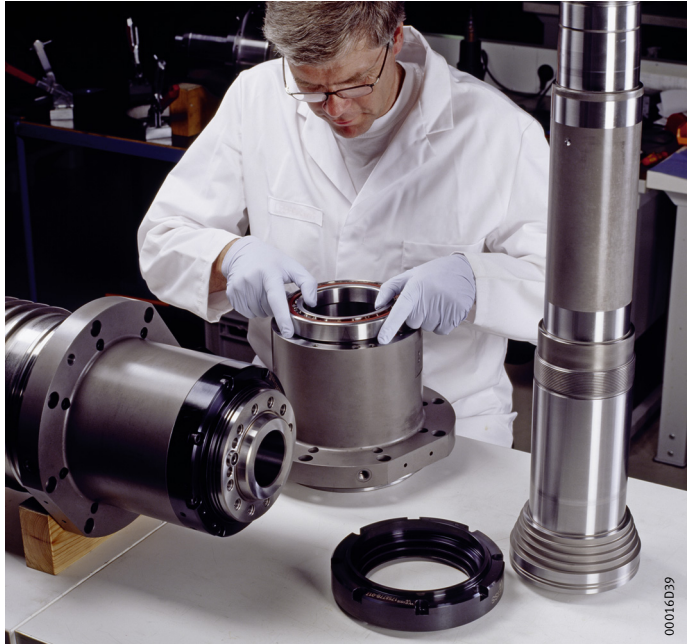
Figure 3 ... lors du montage des broches
