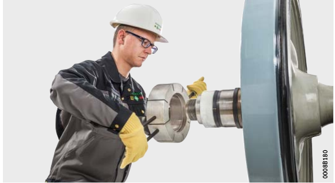
Figure 2 Démontage de la bague intérieure des roulements de boîte d'essieu
