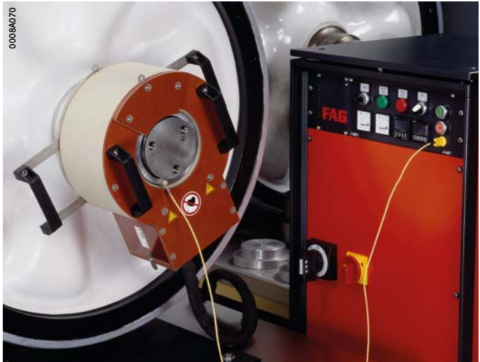
Figure 3 Inducteur rigide pour le démontage de roulements de boîtes d'essieux
