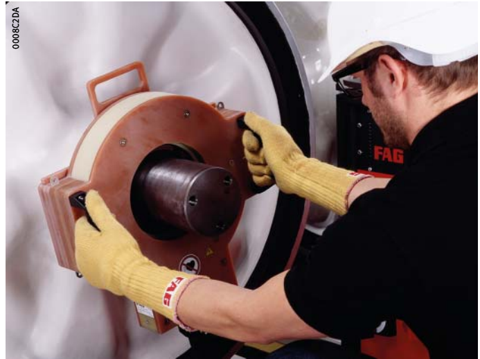
Figure 2 Inducteur rigide pour le démontage de bagues labyrinthes
