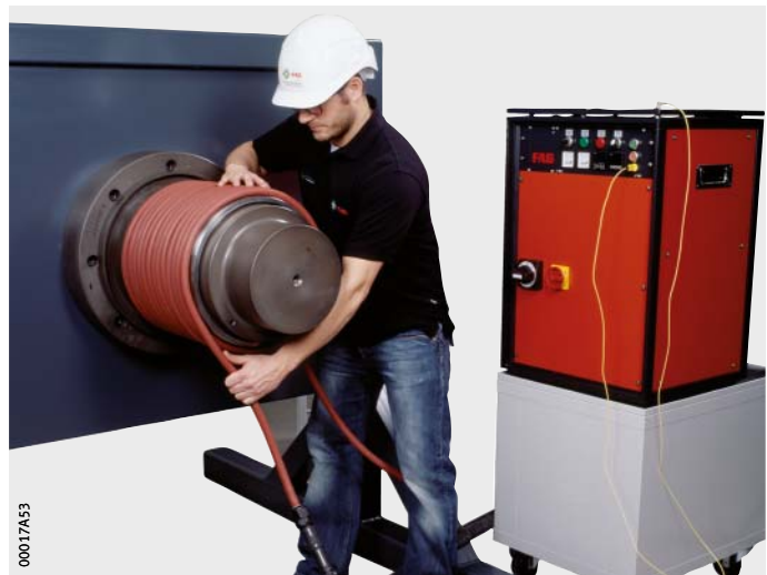
Figure 1 L'inducteur flexible peut être enroulé autour de la pièce
