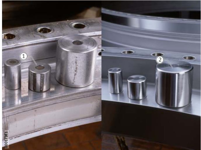
Figure 8 Chemin de roulement et rouleaux avant et après le reconditionnement
