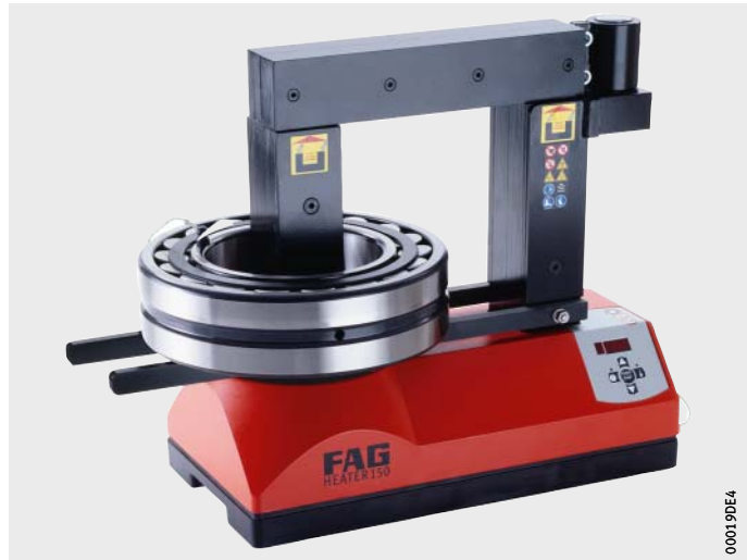
Figure 2 Chauffage du roulement
