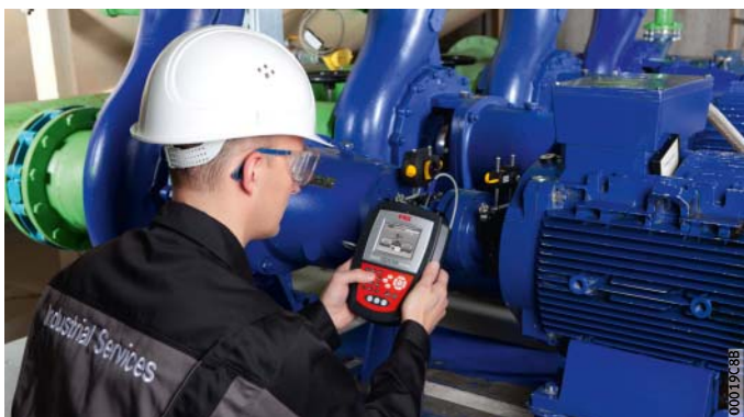
Figure 5 Appareil pour l'alignement des arbres FAG Top-Laser EQUILIGN
